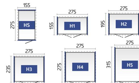
**TIPP:** Sie können das HighLine® ab Gr. H2 ganz nach Ihren Bedürfnissen drehen und die Standardtür kann in jeder Seitenwand eingebaut werden. Ab Gr. H4 ist auch ein seitlicher Einbau der Doppeltür möglich (außermittig).
