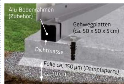
Eine gute und preiswerte Lösung sind im Splittbett verlegte Gehwegplatten. Wir empfehlen unbedingt die Verwendung des **Alu-Bodenrahmens**.
